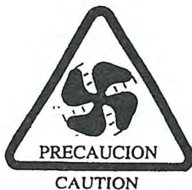
Fig. 6 - Aviso. Ventilador en movimiento.
