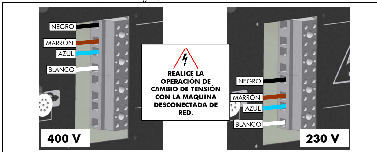
Fig. 5. Sistema de cambio de tensión.
